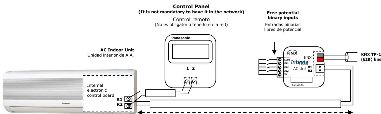
**NOTA:** En algunas unidades interiores no existe el conector R1R2 y en su lugar existen dos cables para la conexión del control remoto. Utilice dichos cables para conectar el bus R1R2. Consulte el manual de usuario de su unidad interior para más información.
