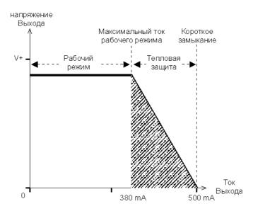
Если ток через нагрузку выхода не превышает максимального тока рабочего режима 380 mA, напряжение на выходе будет немного меньше, чем напряжение питания V+.
