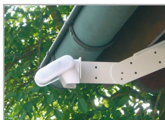
Fig. 7 Esempi di applicazione del braccio articolato: Per mezzo del braccio articolato, la stazione meteorologica sporge dalla copertura della cornice di gronda. Ciò permette l'azione non ostacolata del sole, vento e precipitazioni sui sensori.
