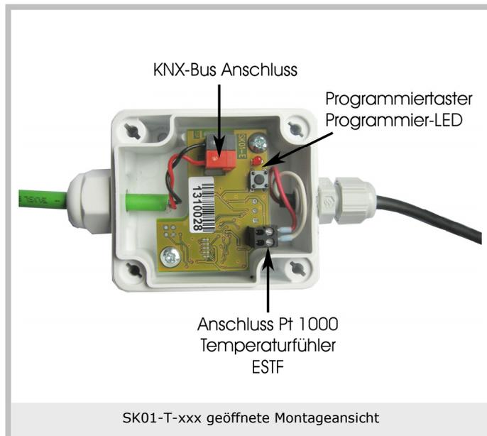
Der Deckel des Messumformers wird durch Drehen der Befestigungsschrauben um 90° gelöst.
